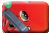
Primer facilitează pornirea chiar și la temperaturi extreme.
